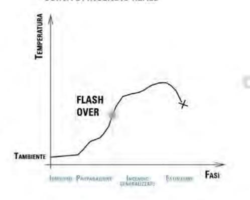
LA CURVA È DIVERSA A SECONDA DEL TIPO DI COMBUSTIBILE
